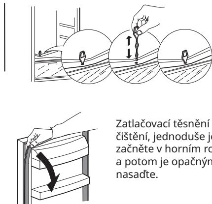
Zatlačovací těsnění umožňuje snadné čištění, jednoduše je vyjměte z uložení, začněte v horním rohu podle obrázku a potom je opačným postupem znova nasadte.
