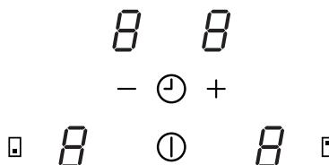
La prima conectare a aparatului la rețeaua de alimentare casnică, instalatorul trebuie să seteze puterea zonelor de gătit în funcție de capacitatele efective ale instalației electrice casnice.
