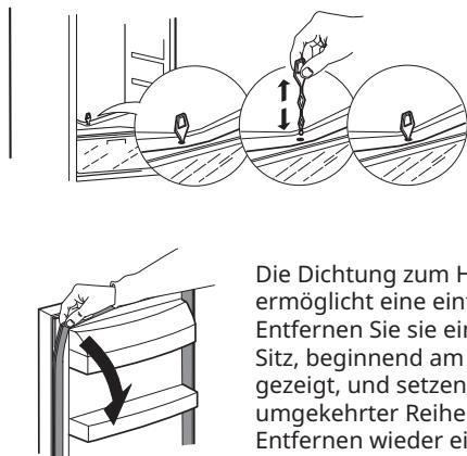
Die Dichtung zum Hineindrücken ermöglicht eine einfache Reinigung. Entfernen Sie sie einfach aus ihrem Sitz, beginnend am oberen Eckteil wie gezeigt, und setzen Sie sie dann in umgekehrter Reihenfolge wie beim Entfernen wieder ein.
