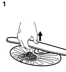
Um den unteren Sprüharm zu entfernen, ziehen Sie ihn nach oben.
