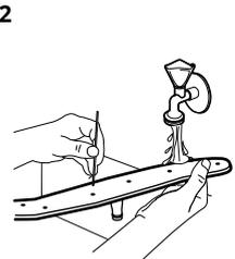
Reinigen Sie den Sprüharm unter fließendem Wasser. Entfernen Sie Verunreinigungen aus den Öffnungen des Sprüharms mit einem spitzen Gegenstand, z.B. einem Zahnstocher.
