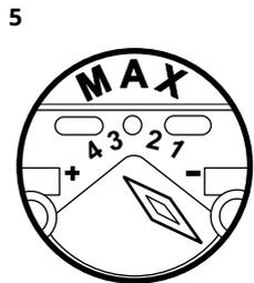
Sie können die Zugabemenge des Klarspülmittels einstellen, indem Sie den entsprechenden Regler zwischen Position 1 (geringste Menge) und Position 4 (größte Menge) einstellen.
