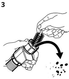
Reinigen Sie den Filter des Zulaufschlauchs.
