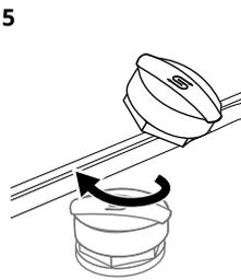
Drehen Sie den Deckel des Salzbehälters im Uhrzeigersinn, um den Salzbehälter zu schließen.
