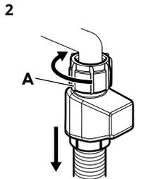
Nehmen Sie den Schlauch ab. Drehen Sie die Halterung A nach rechts.
