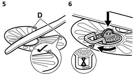
Setzen Sie das flache Sieb (A) wieder ein. Stellen Sie sicher, dass es korrekt unter den beiden Führungen (D) eingesetzt wurde.
