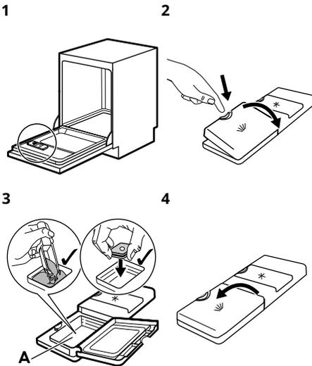
Füllen Sie das Reinigungsmittel ein oder legen Sie die Multi-Tablette in das Fach (A).
