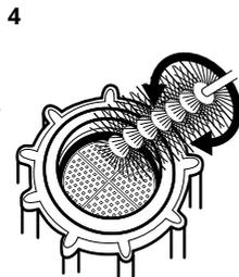
**Reinigen des unteren Sprüharms**
