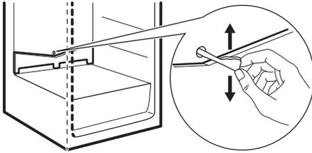
Bei normalem Betrieb wird Reif bei jedem Anhalten des Kompressors automatisch vom Verdampfer des Kühlschranks entfernt. Das Tauwasser sammelt sich in einer Auffangrinne und läuft durch eine Abflussöffnung in einen speziellen Behälter an der Rückseite des Geräts über dem Kompressor, wo es verdampft.
