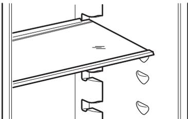
Die Wände des Kühlschranks sind mit einer Reihe von Führungsschienen ausgestattet, die verschiedene Möglichkeiten für das Einsetzen der Ablagen bieten.
