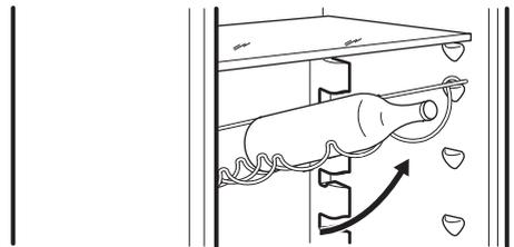
Der Flaschenhalter kann gekippt werden, um geöffnete Flaschen zu lagern. Stellen Sie hierfür die vorderen Haken des Halters eine Ebene höher als die hinteren Haken ein.
