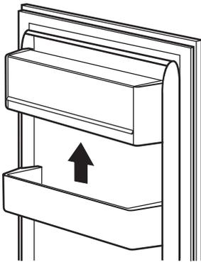
Die Türablagen können in verschiedener Höhe positioniert werden; damit ermöglichen sie das Lagern verschieden großer Lebensmittelpackungen.
