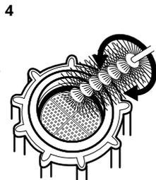
**Reinigen des unteren Sprüharms**
