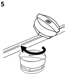
Drehen Sie den Deckel des Salzbehälters im Uhrzeigersinn, um den Salzbehälter zu schließen.
