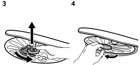
Zum Entfernen der Siebe (B) und (C) drehen Sie den Hebel gegen den Uhrzeigersinn und heben Sie die Siebe heraus. Nehmen Sie das Sieb (C) aus dem Sieb (B). Reinigen Sie die Siebe mit Wasser.
