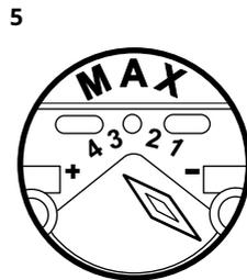
Sie können die Zugabemenge des Klarspülmittels einstellen, indem Sie den entsprechenden Regler zwischen Position 1 (geringste Menge) und Position 4 (größte Menge) einstellen.
